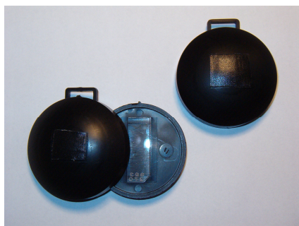
Exempel på spårfilmsdosor som används vid mätning i bostäder.
